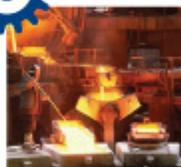
La **forgiatura** (o **fucinatura**) è una lavorazione per deformazione plastica effettuata in genere a caldo manualmente con martello o meccanicamente.
