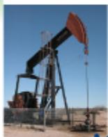
Il meccanismo **biella-manovella** trasforma un movimento rettilineo alternato in moto circolare continuo o viceversa.
