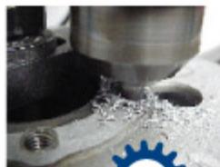
La foratura è una lavorazione meccanica che consiste nell'esecuzione di fori cilindrici passanti o ciechi per asportazione di truciolo.
