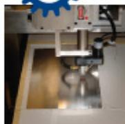
L'**elettroerosione** è una tecnologia di lavorazione ad asportazione di truciolo che utilizza le capacità erosive delle scariche elettriche.
