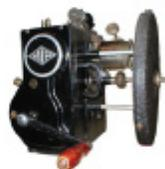
L'**intermittente** è un altro meccanismo che trasforma un moto rotatorio continuo in moto rotatorio intermittente, ed è composto da una ruota stellare e da una camma.
